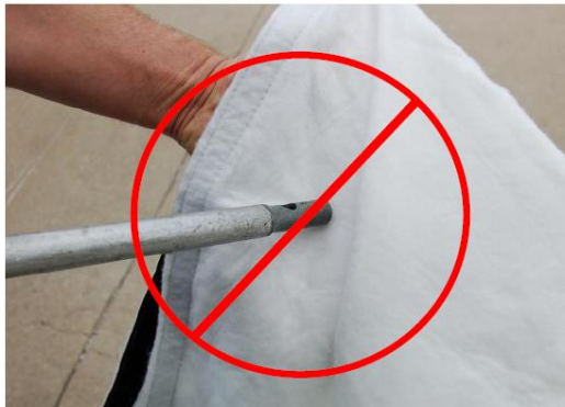
LIMPIE LIGERAMENTE CON AIRE COMPRIMIDO SOLAMENTE, DESDE DENTRO HACIA FUERA. MANTENER LA BOQUILLA ENTRE 15-30 CENTIMETROS DEL TEJIDO
